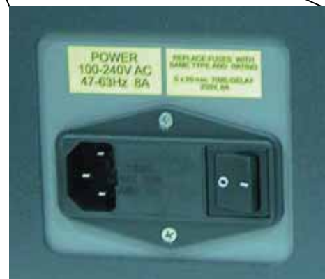
Mini 18 Power Receptacle
